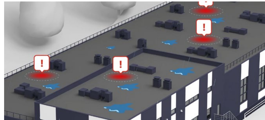
VILPE Sense -vuotopaikantamisjärjestelmää havaitsee mahdolliset vuodot nopeasti.
