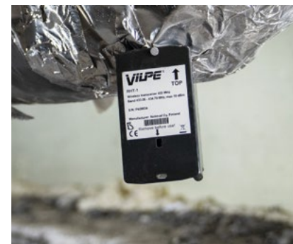
Till vänster: VILPE Sense-utomhusgivarna fästa på ytterväggen. Bostadsbolaget har två VILPE Sense-system och därmed två utomhusgivare. Till höger: VILPE Sense-inomhusgivare i kryppgrunden.
