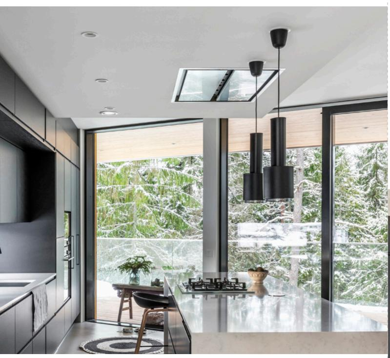
Единое пространство кухни-студии даёт ощущение простора и делает рабочее место кухни частью общей комнаты. Встраиваемая потолочная вытяжка, управляющая внешним двигателем, идеально подходит для дизайна такой студии. Полностью интегрируемое в потолок устройство с рамкой из нержавеющей стали имеет яркое светодиодное освещение, а управление осуществляется дистанционным пультом.
